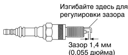
**Рис. 12. Регулировка зазора свечи зажигания, нагреватель мощностью 10 кВт**
